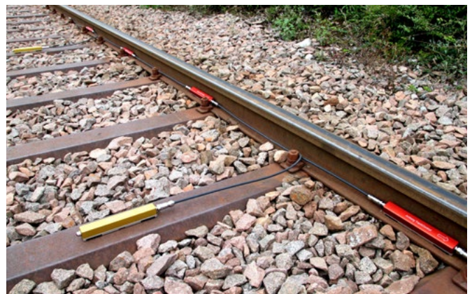
Effiziente Installation mit neuester Sensorgeneration! Amberg TrackControl Pro mit flexiblen Steckverbindungen und innovativer Magnet-Befestigung.
