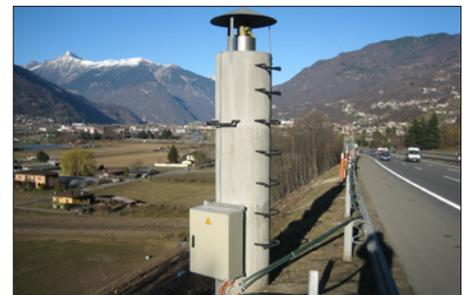
Messpfeiler mit Tachymeter
