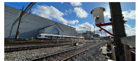
Gleisüberwachung mittels Totalstation
